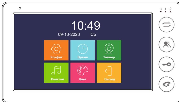
Для корректной работы монитора в системе очень важно правильно установить номер устройства (ID). Для главного монитора установите значение «1». Остальные, зависимые мониторы, должны быть установлены под номером 2/3/4/5/6 (см. схему подключения).
